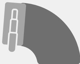
La aplicación de las capas debe de ser realizadas con motivos cortos y semicirculares dejando la superficie bien cubierta, dejando la menor cantidad de imperfecciones posibles. Dejar secar bien entre capas y aplicar la capa siguiente hasta lograr un soporte uniforme.
